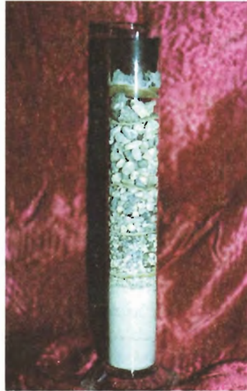
Ἱζηματικὴ διάταξη τῶν στοιχείων τοῦ ἀρχαίου τοιμέντου τῆς Καμίρου σὲ γυάλινο σωλήνα. (Φωτογραφία Εὐστ. Εὐσταθιάδου.)
